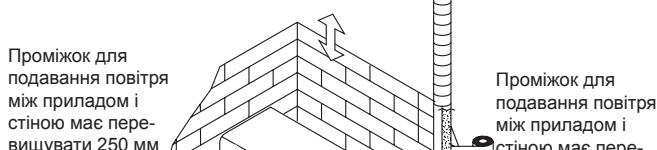
Проміжок для подавання повітря між приладом і стіною має перевищувати 250 мм
